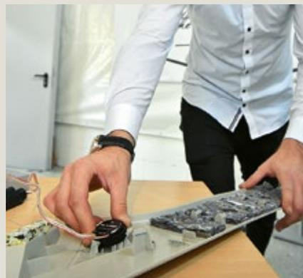
**3** Im Bild: Die Originalverkleidung der Fiat-A-Säule. Für die Montage im Ducato musste Thorsten Wissler die Gladen-Montagearme am Hochtöner ausklipsen und diesen in die Fiat-Halterung einrasten. Schade – besser klingt das System in der Remis-Verkleidung, implantiert mit der Gladen-Befestigung.
