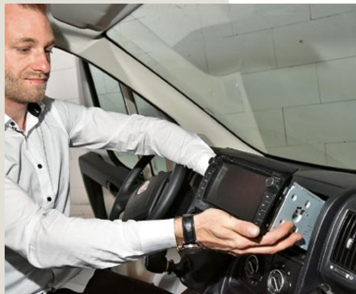
**6** Abschließend: Der Naviceiver wird zurück in den Schacht geschoben und fixiert. Fertig und Klangprobe ...
