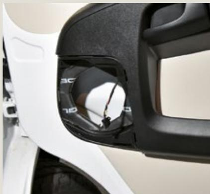
**2** Der Original-Fiat-Lautsprecher ist demontiert, der Einbaurahmen mit einer Dämm-Matte ausgekleidet.
