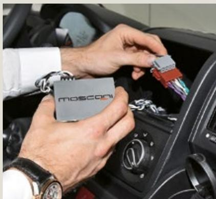
**5** Um den winzigen Mosconi Pico 2.0 zu installieren, muss der Naviceiver kurz aus dem Einbauschaft gezogen werden. Ist das passiert, wird der Verstärker mit eigenem Kabelsatz in die Verkabelung des Radios eingesteckt. Zeitaufwand hierfür (wenn Radioschaft offen): nur wenige Sekunden.
